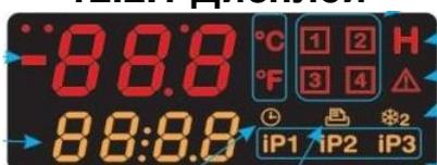
Рис. 11 Дисплей контроллера
